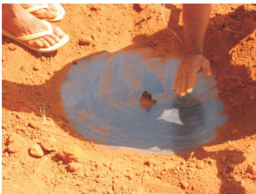
Figura 15. Furo na lona causado pela movimentação da enxada.
