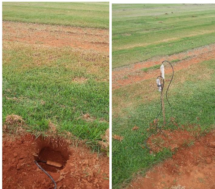
Figura 4. Instalação dos IRRIGAS® na área de gramados, grama esmeralda.
