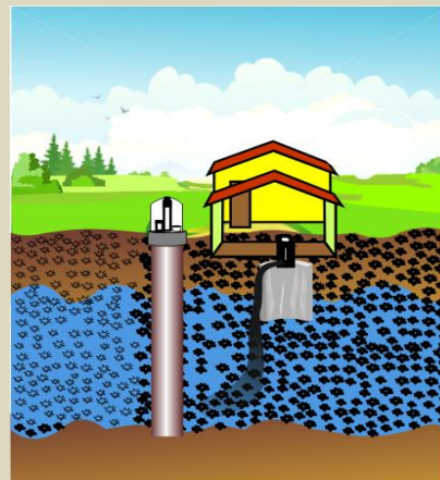
Figura 5: Desenho ilustrando a contaminação de cisterna pela fossa
