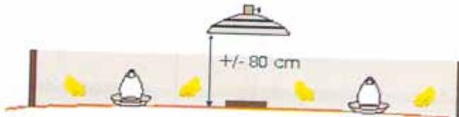
Figura 24. Vista lateral do círculo de proteção com altura da campânula.
