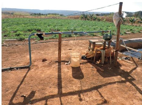
**Figura 7.** Cabeçal de controle para irrigação por gotejamento
