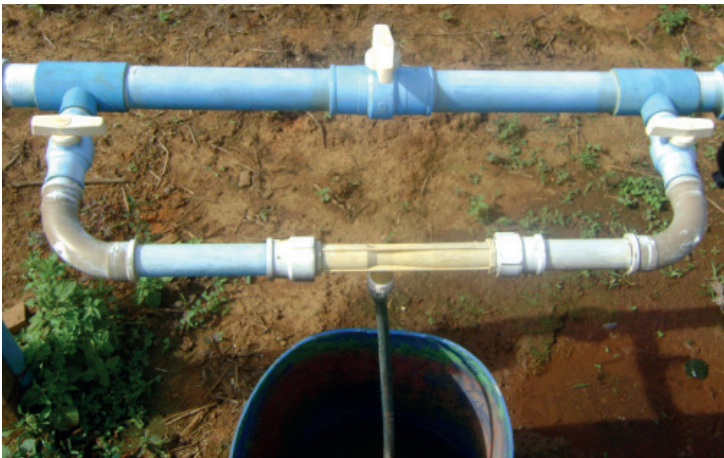
Figura 11. Detalhe do injetor de fertilizantes
