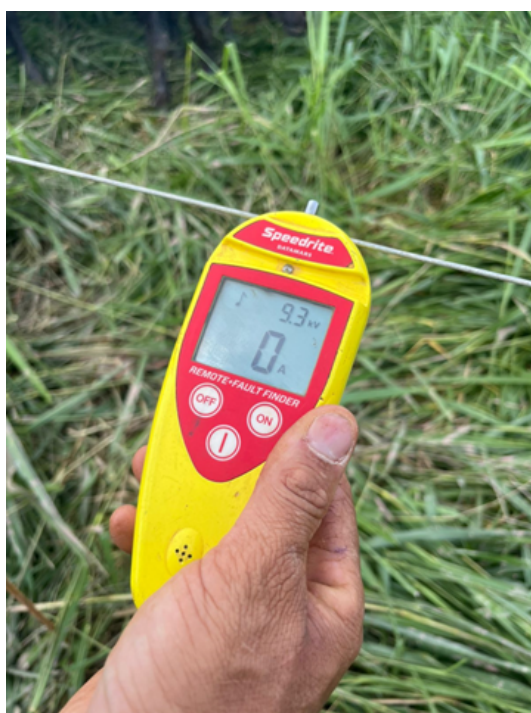
Figura 03. Teste de eficiência de choque da cerca elétrica. Fonte: Emater-DF
