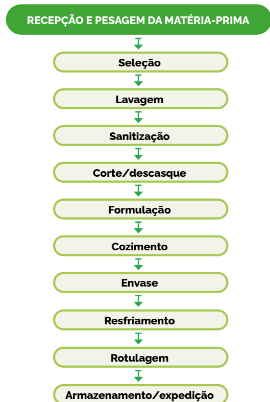
Figura 10. Modelos de fluxograma padrão de geleias. Fonte: Modelos de agroindústrias rurais, Emater-DF, 2023.
