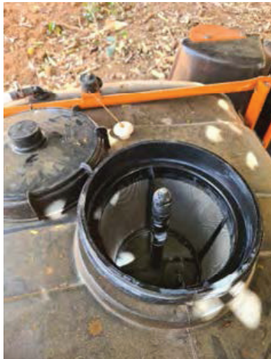
Figura 06. Verificação se o filtro está limpo e sem furos Fonte: Felipe Cardoso
