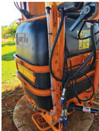
Figura 04. Tanque de armazenamento da calda feito de plástico Fonte: Felipe Cardoso
