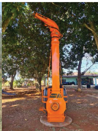
Figura 02. Pulverizador atomizador com sistema de direcionamento de fluxo de ar mais alta para pulverização de bananeiras.
