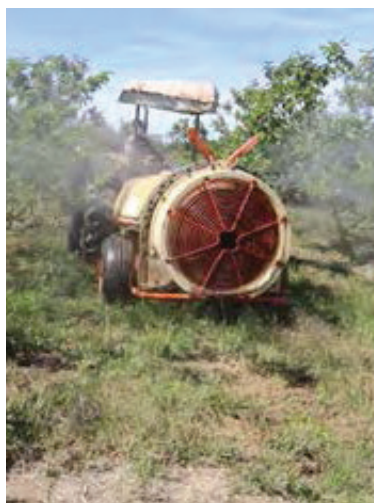
Figura 01. Pulverizador turbo atomizador acoplado na barra de tração de trator utilizado para pulverização de frutíferas de porte baixo e médio.
