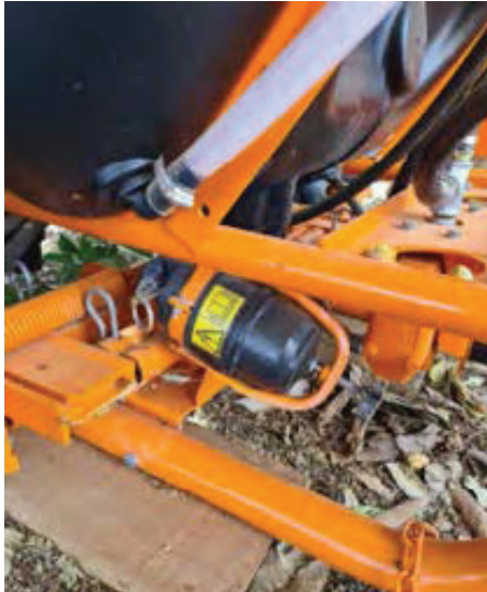
Figura 09. Filtro de sucção em perfeito estado de conservação. Fonte: Felipe Cardoso
