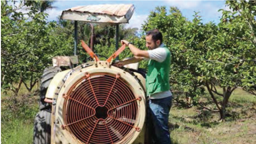
Figura 13. Regulagem da posição dos defletores para evitar que a calda caia no chão ou ultrapasse a altura da planta. Fonte: Felipe Cardoso
