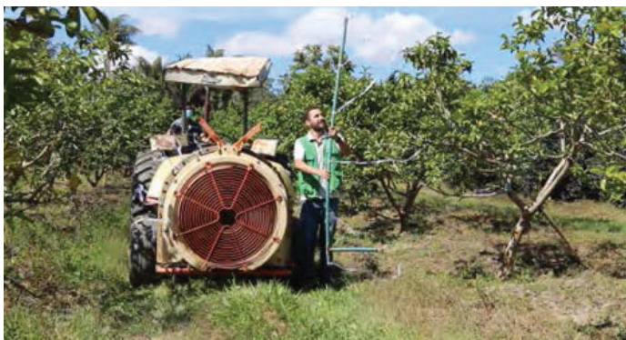
Figura 12. Fitilhos amarrados no ventilador (à esquerda) para regulagem da direção dos bicos pulverizadores e utilização de barra com fitilhos (à direita) para auxiliar na regulagem dos bicos e defletores. Fonte: Felipe Cardoso
