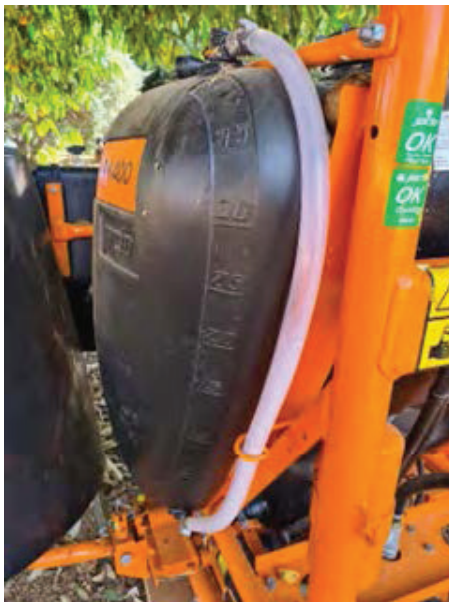
Figura 07. Mangueria indicadora de nível do tanque transúcida e sem rachaduras. Fonte: Felipe Cardoso
