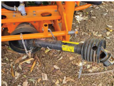
Figura 03. Cardan que acopla o pulverizador ao trator Fonte: Felipe Cardoso
