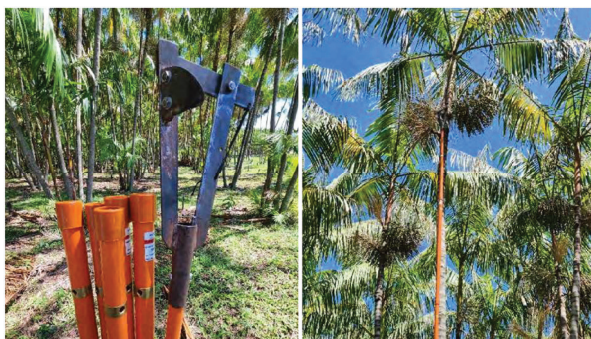
Figura 06. A) Detalhe do equipamento com garra, lâmina de corte e tubos leves de plástico utilizado na colheita. B) Colheita dos cachos de açaí em plantas altas.
