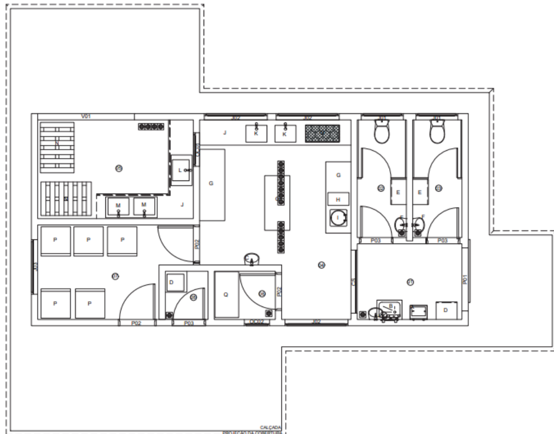
LOCAÇÃO DE MÁQUINAS E EQUIPAMENTOS ESCALA 1:75
