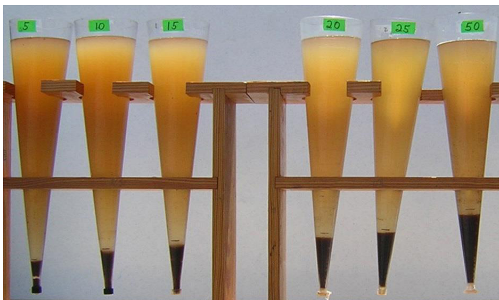
Figura 01. Diferentes concentrações de bioflocos verificadas pelo cone de Imhoff.
