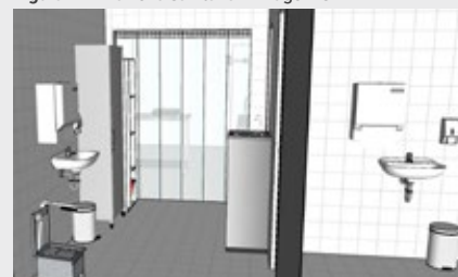
Figura 24 – Barreira sanitária – Imagem 3D
