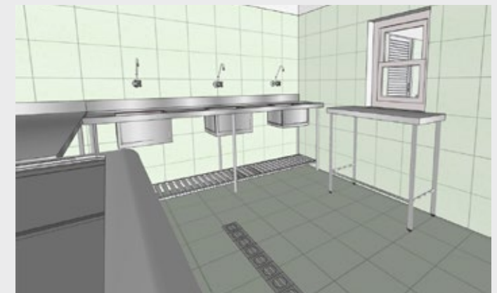
Figura 62 – Imagem 3D da recepção e descasque da fábrica de pequeno porte de processamento de frutas
