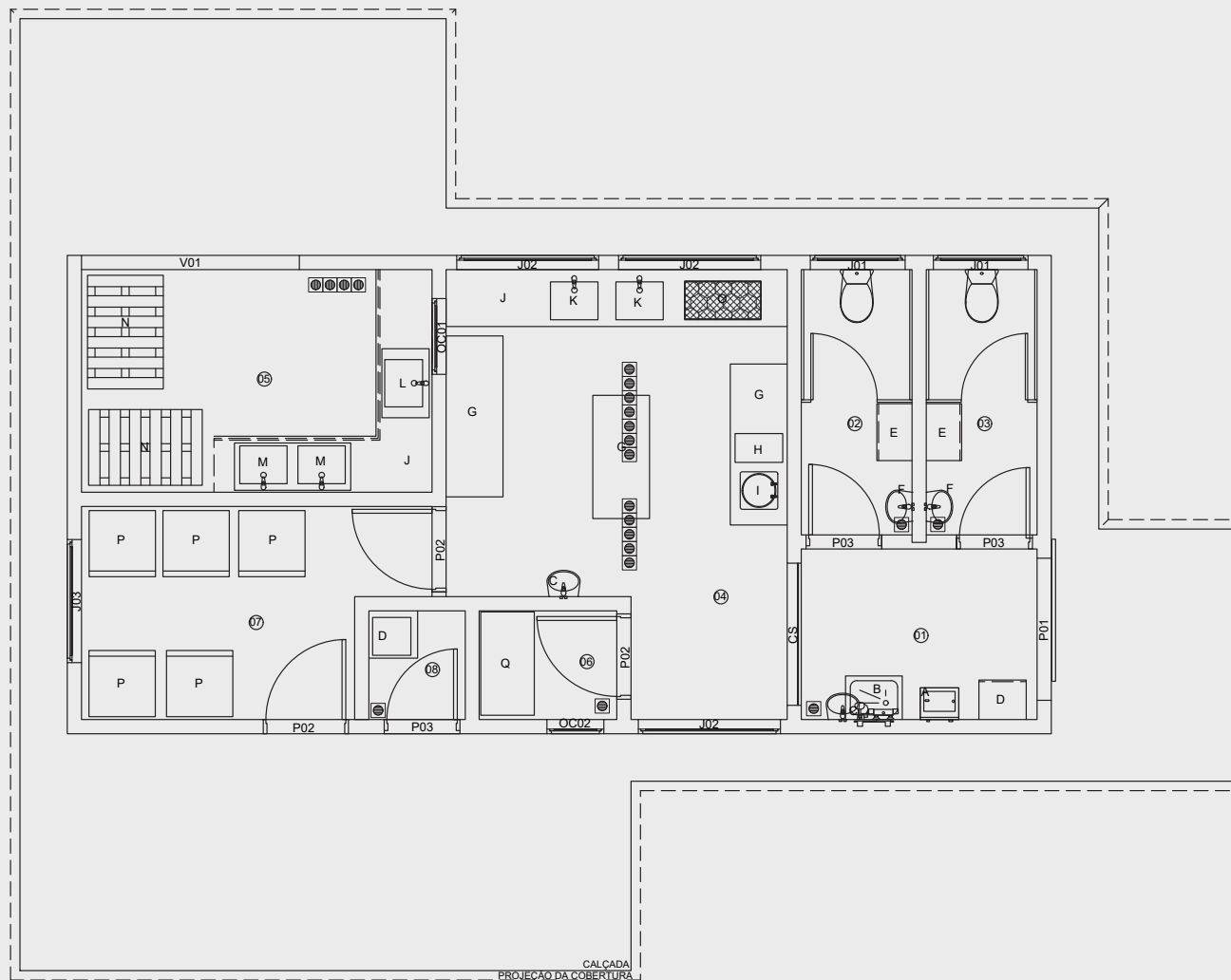
LOCAÇÃO DE MÁQUINAS E EQUIPAMENTOS ESCALA 1:75
