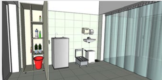
Figura 49 – Imagem 3D da barreira sanitária da agroindústria de mandioca descascada congelada, com bebedouro e DML
