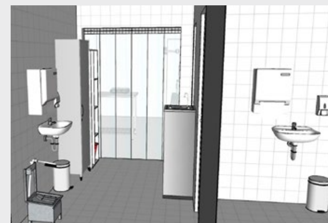
Figura 40 – Barreira sanitária – Imagem 3D
