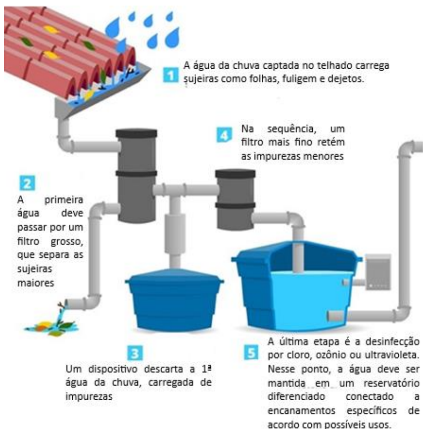
Figura 03. Esquema de captação de água da chuva.
