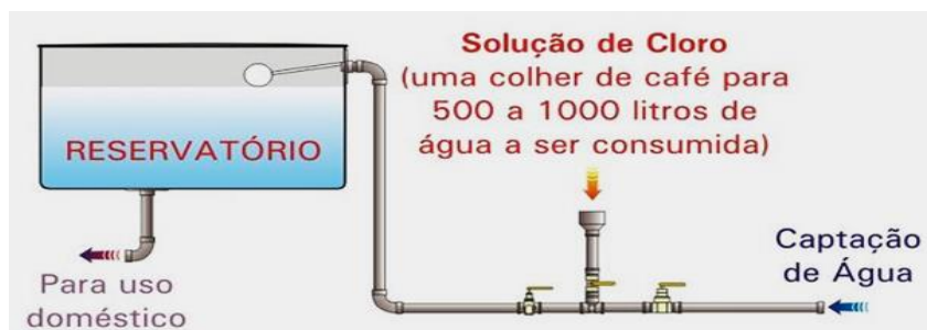
Figura 04. Esquema representativo do Clorador Embrapa.
