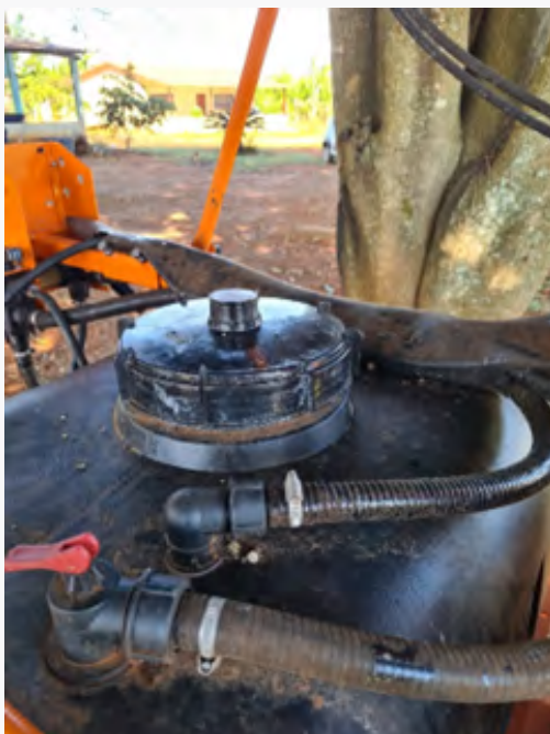
Figura 05. Tampa do tanque em bom estado de conservação Fonte: Felipe Cardoso
