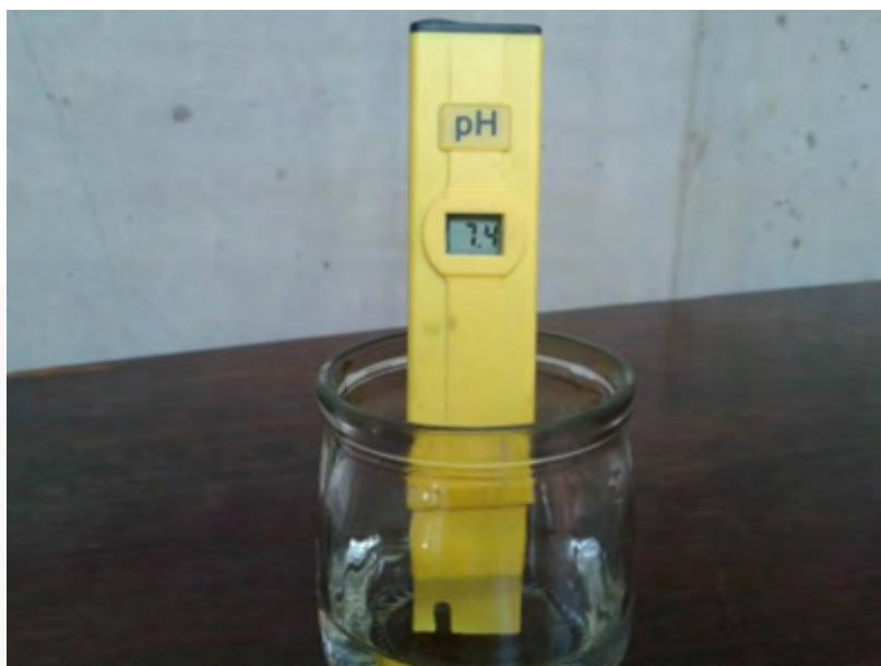
Figura 14. Merdidor de Ph
