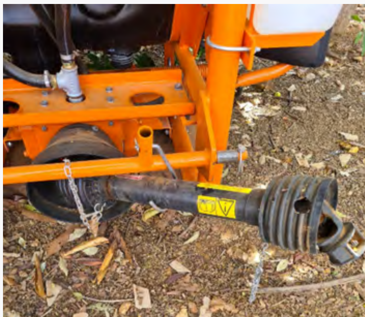
Figura 03. Cardan que acopla o pulverizador ao trator Fonte: Felipe Cardoso
