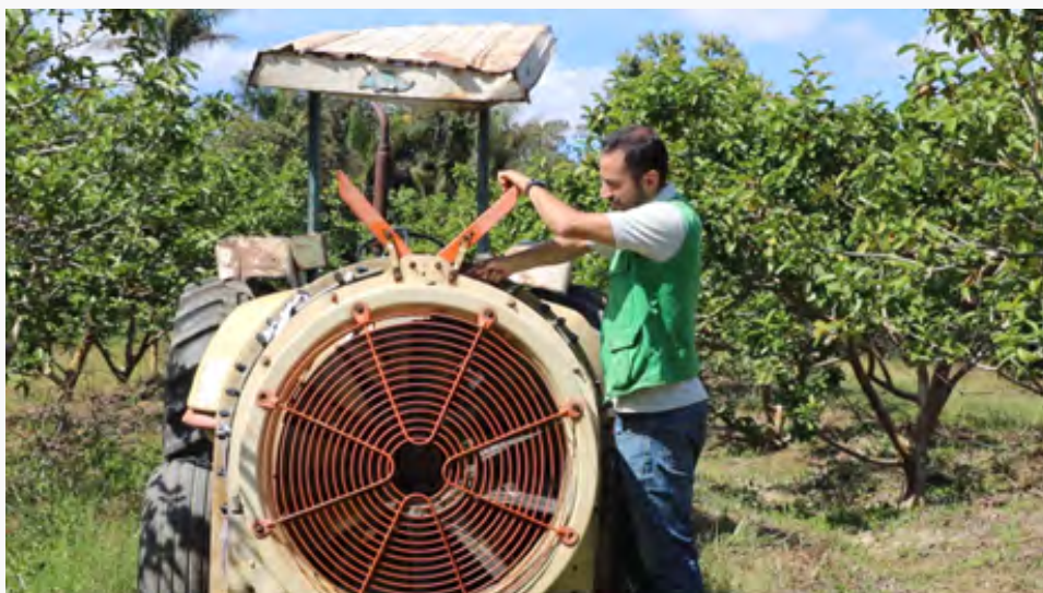
Figura 13. Regulagem da posição dos defletores para evitar que a calda caia no chão ou ultrapasse a altura da planta.
