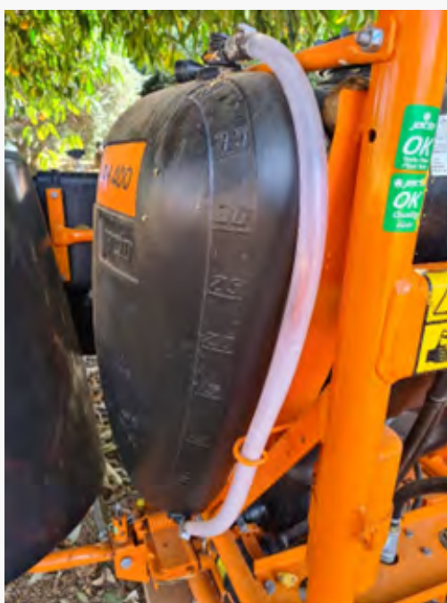
Figura 07. Mangueira indicadora de nível do tanque translúcida e sem rachaduras. Fonte: Felipe Cardoso
