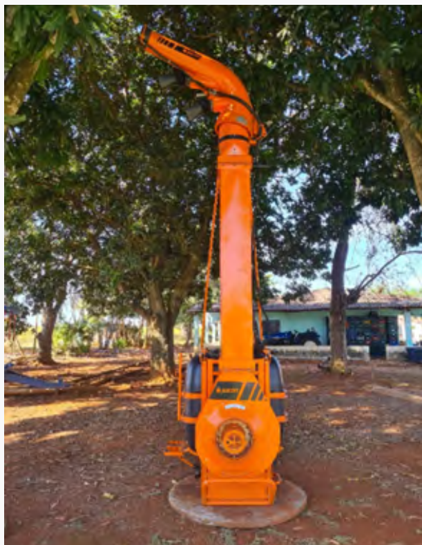
Figura 02. Pulverizador atomizador com sistema de direcionamento de fluxo de ar mais alta para pulverização de bananeiras.
