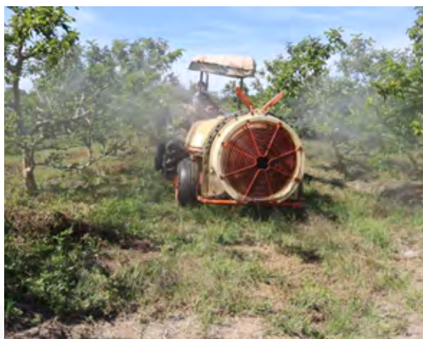
Figura 01. Pulverizador turbo atomizador acoplado na barra de tração de trator utilizado para pulverização de frutíferas de porte baixo e médio.
