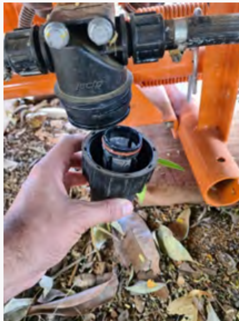
Figura 10. Desmontagem do filtro de linha para verificar excesso de impurezas e necessidade de lavagem da malha. Fonte: Felipe Cardoso
