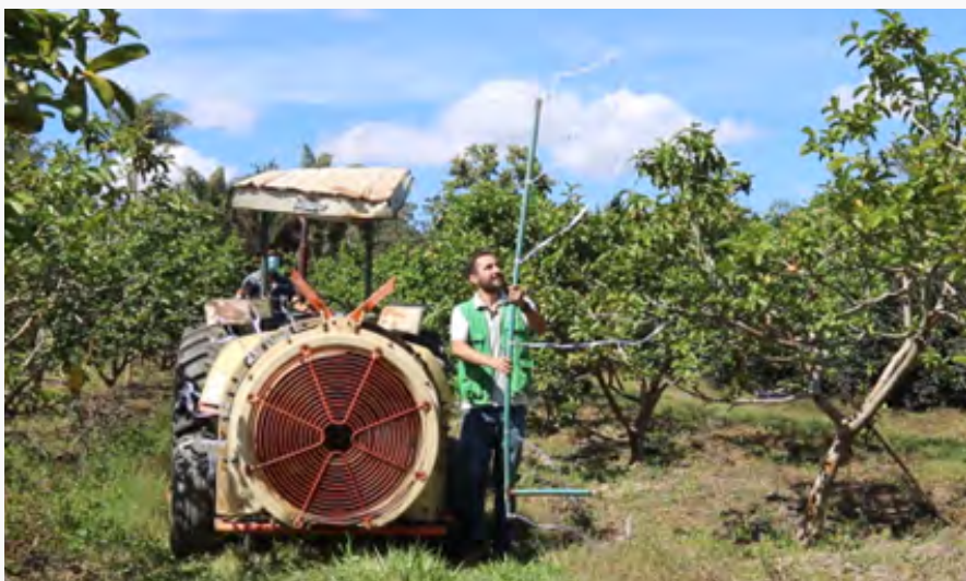
Figura 12. Fitilhos amarrados no ventilador (à esquerda) para regulagem da direção dos bicos pulverizadores e utilização de barra com fitilhos (à direita) para auxiliar na regulagem dos bicos e defletores. Fonte: Felipe Cardoso
