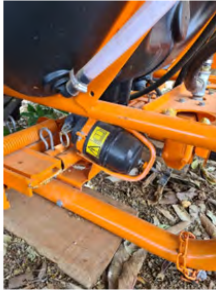
Figura 09. Filtro de sucção em perfeito estado de conservação. Fonte: Felipe Cardoso
