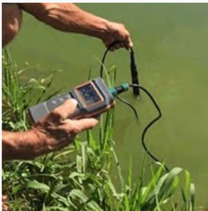
Figura 4. Oxímetro: aparelho medidor de oxigênio dissolvido
