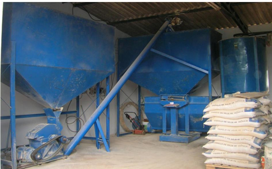
Figura 33. Fábrica de ração. Da esquerda para a direita: triturador de milho, balança para pesagem de fubá de milho, misturador vertical e sacos de farelo de soja. Fonte: José Gonçalves.
