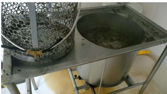
Figura 38. Tanque de escaldagem. Fonte: José Gonçalves.
